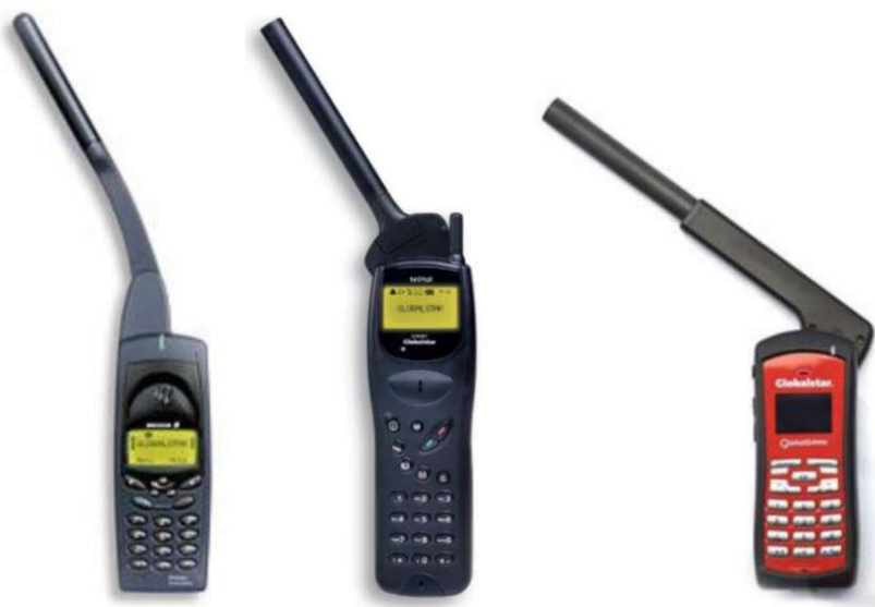
Рисунок 3.5. Портативные абонентские мобильные терминалы ССППС Globalstar
